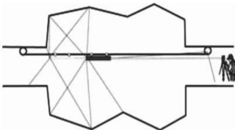
20 Сурет – Қиын қол жетпейтін кен қазбасын сканирлеу схемасы
